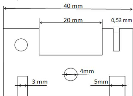
Si l'hameçon loge dans l'ouverture horizontale de 20 mm l'épaisseur du corps ne peut pas dépasser l'ouverture verticale de 5 mm .
